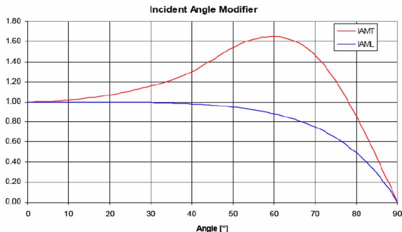
Como se puede ver en el gráfico arriba, el colector TUBOSOL de Amordad tiene una curva que es completamente diferente a los otros colectores planos convencionales (FP) e incluso los paneles con reflectores. Esto es debido al área cilíndrico de los tubos, que continúan absorbiendo los rayos del sol a lo largo del día.
