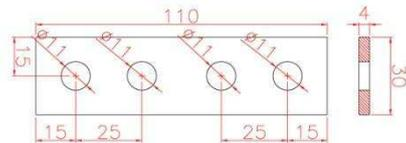
Cotas estructuras T25PS cubierta plana
